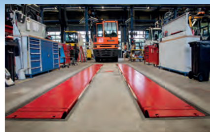
Version encastrée avec système de protection anti-descente
