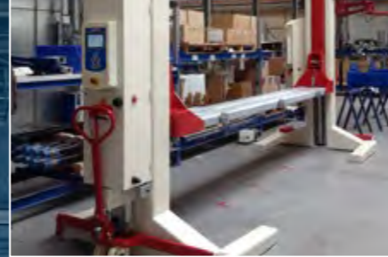
Traverse disponible pour le levage par trains de roulement ou châssis.
