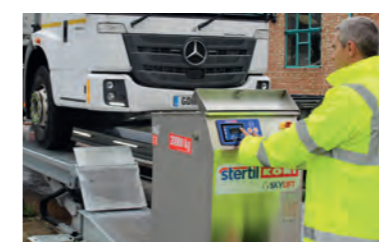
Console de commande en acier inoxydable
